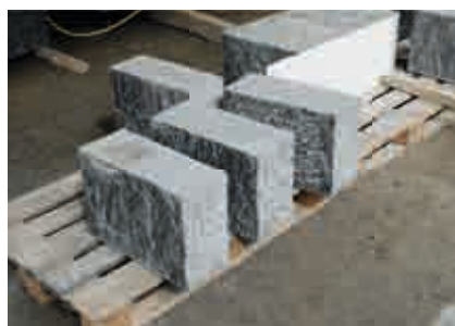
Abb.4: Konsolsteine, drei Steine vorne rechts: Häupter punktgespitzt, Lagerflächen der beiden Steine vorne links gespalten (a spacco), hinten rechts punktgespitzt
