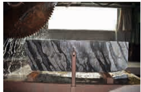
Abb.8: Herstellung gesägter Werkplatten aus rötlichem Kieselkalkstein
