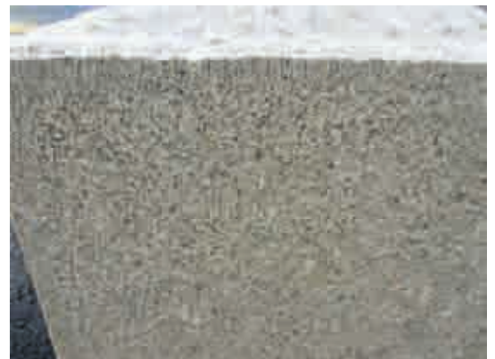
Abb.5: Muster mit gestockter Fläche und Randschlag
