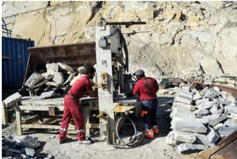
Abb.4: Produktion von Mauersteinen mit der Keilspaltmaschine
