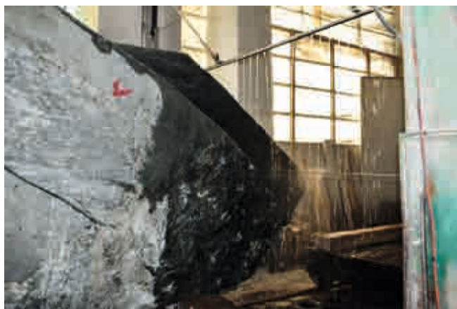
Abb.3: Blöcke werden im Werk aufgesägt
