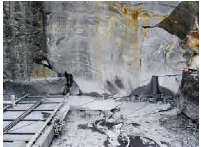
Abb.2: Basisschnitt mit Seilsäge
