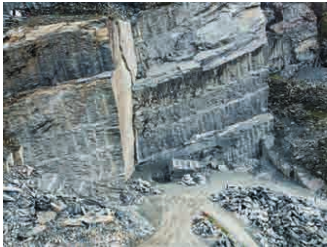
Abb.2: Steinbruch Sasso Corvi: Schieferung flach nach links, Hauptkluftsystem K1 («taglio maestro») steil nach rechts einfallend
