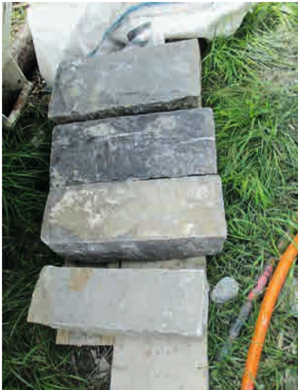
Abb.2: Gespaltene Steine, ebenmässig und lagerhaft
