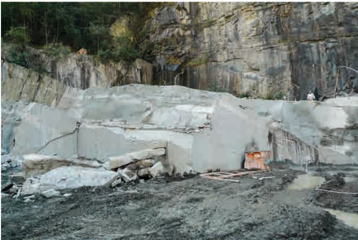
Abb.2: Abbau mit der Seilsäge im Steinbruch in Bodio
