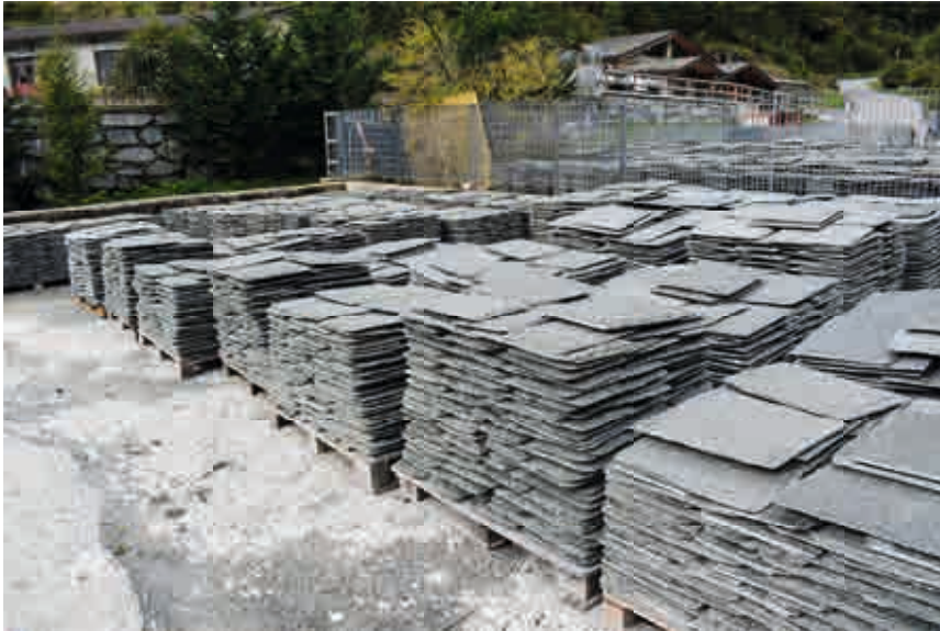
Abb.5: Dünne Dachplatten aus Schieferserpentin
