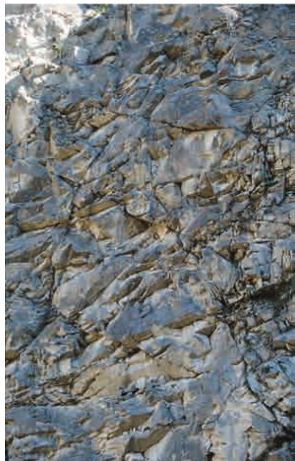
Abb.3: Intensiv geklüfteter Felsverband im Steinbruch Farrirola
