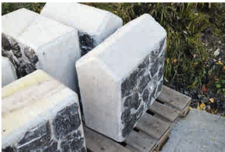
Abb.7: Vorgefertigte natursteinverblendete Betonelemente
