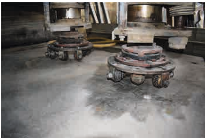
Abb.5: Rollenhammer zur Herstellung gestockter Oberflächen
