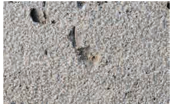
Abb.3: Gestockte offenporige Oberfläche
