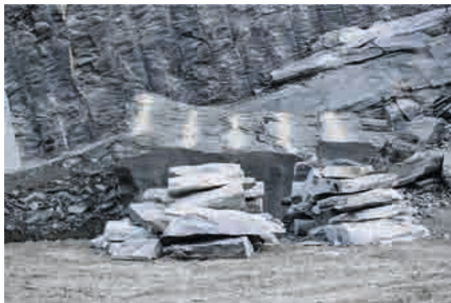
Abb.3: Hintergrund: Sprenglöcher lotrecht zur Schieferung
