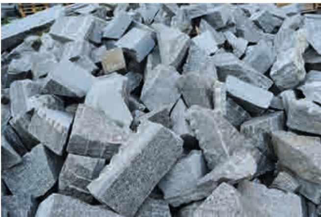
Abb.2: Gemischtes Steinlager im Werk, typisch sind die sauberen Winkel und Spaltflächen
