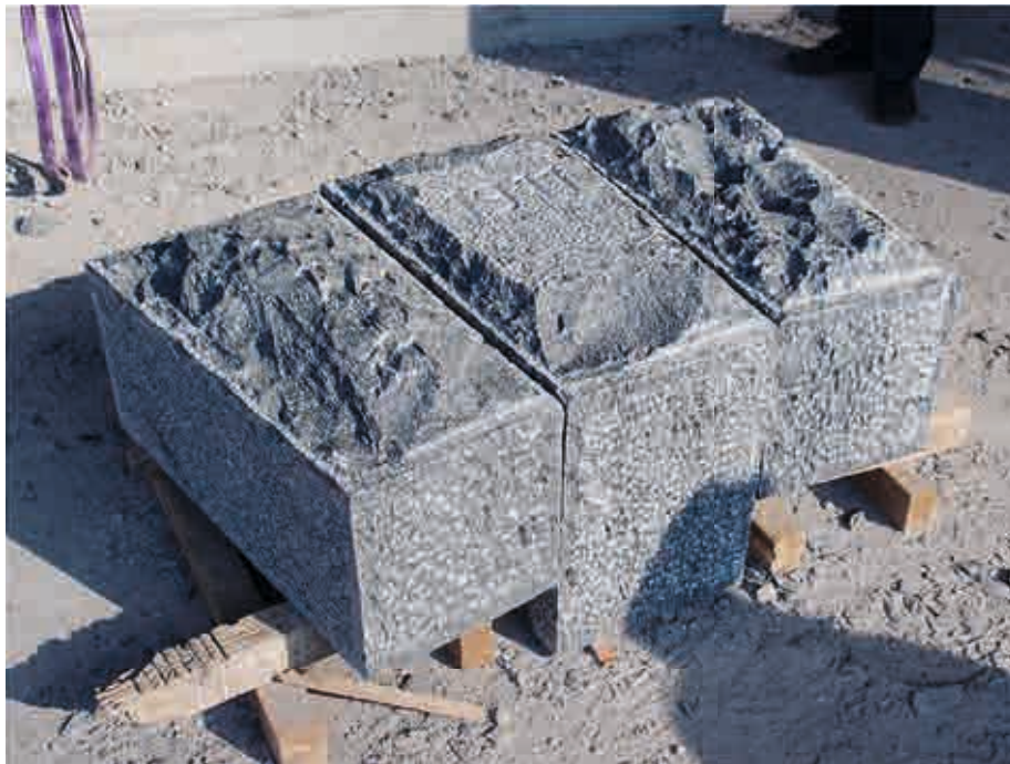
Abb.3: Kranzsteine Portal Sasslatsch-Tunnel mit Bosse und Randschlag, hergestellt im Werk Ongaro, Cresciano
