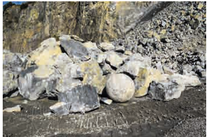
Abb.2: Mittels Stahlkugel zerkleinerte Blöcke
