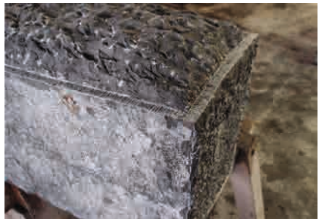
Abb.8: Kranzstein im Werk mit Bosse und Randschlag
