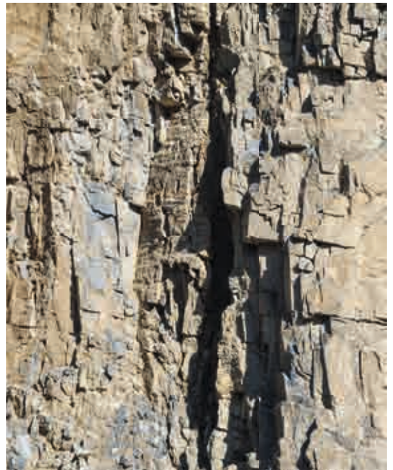
Abb.7: Engständig geklüfteter Fels im Abbauperimeter
