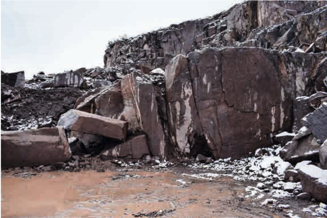
Abb.2: Abbau mit Seilsäge (Basisschnitt) und Sprengungen (in subvertikale Bohrlöcher platziert)
