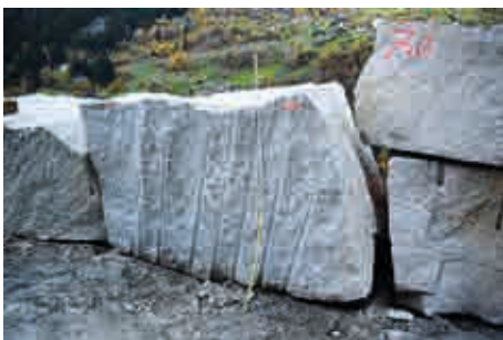
Abb.2: Block, entlang von Bohrlöchern gespalten
