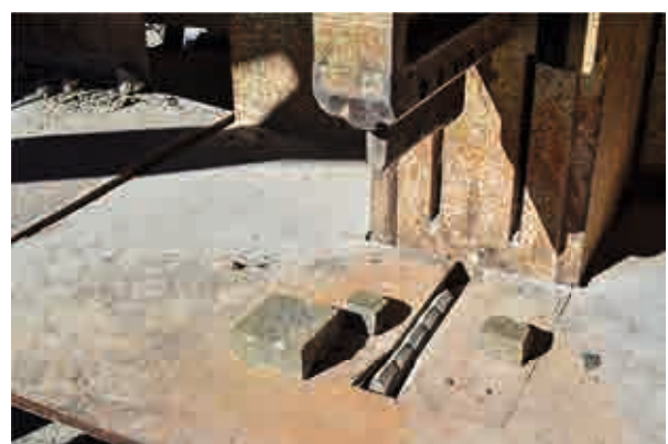
Abb.7: Kleine Steinwürfel, hergestellt mit der Keilspaltmaschine
