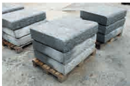
Abb.3: Abdeckplatten, Kanten gefast (incollato), Häupter punktgespitzt (appuntato)
