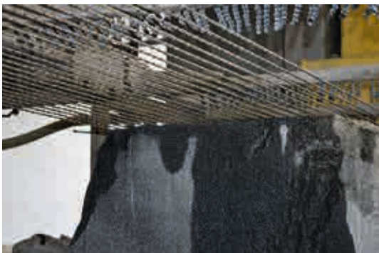
Abb.4: Effiziente Mehrfach-Seilsäge «multifilo»
