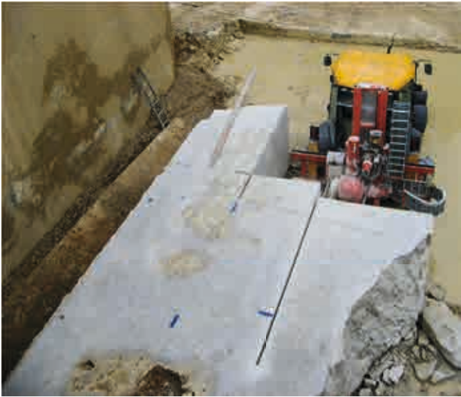
Abb.2: Rechtwinklige Blöcke werden direkt aus dem anstehenden Fels geschrämt
