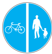
Via da velo e senda cun surfatschas da traffic separadas (nr. 2.63 OSV)
