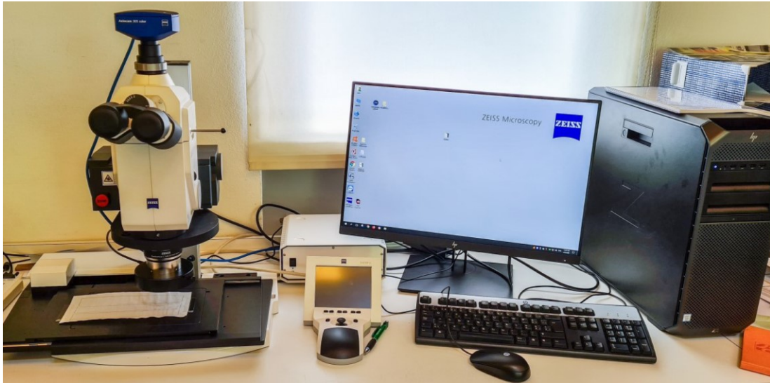
Figura 3: Il nuovo microscopio Axiolab Zoom.V16 della Zeiss permette alla SUPSI un'ulteriore possibilità di verificare se sui bastoncini di legno sono presenti uova di zanzara tigre. (Foto: SUPSI, 2020)
