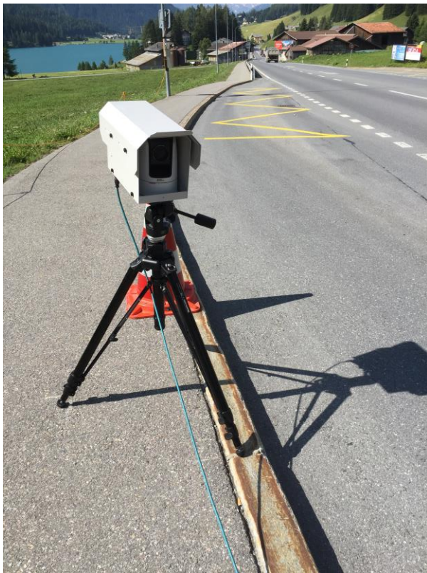
Abbildung 2: RSD-Messsystem bei Davos Wolfgang. Oben links: Lichtquelle und Spektrometer, oben rechts: Lichtquelle, Geschwindigkeits- und Beschleunigungsmesser, unten links: Kamera zur Erfassung von Kennzeichen (Foto der Fahrzeugrückseite und anschließende Kennzeichenerkennung), unten rechts: Übersicht mit Messfahrzeug, Lichtquelle und Reflektometer (Mittelinsel).
