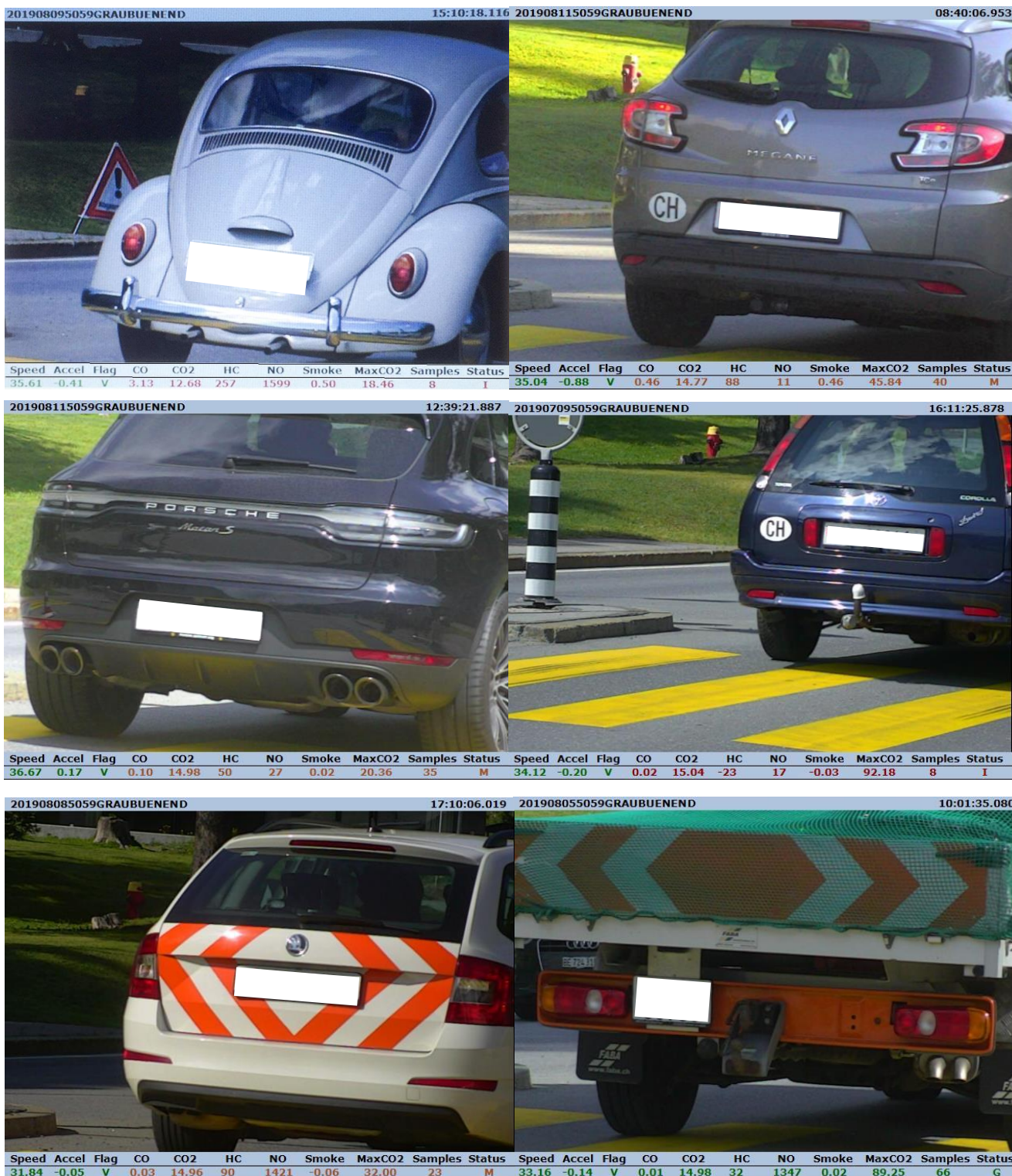
Abbildung 3a: Beispiele von Kameraaufnahmen während einer RSD-Messung. Das Bild zeigt das jeweils gemessene Fahrzeug. Auf dem Bild sind zudem die Schadstoff-Konzentrationen sowie Informationen zu Geschwindigkeit und Beschleunigung des Fahrzeuges ersichtlich. 1. Reihe: Personenwagen Benzin Wechselnummer (Remo Fehr, ANU), Personenwagen Benzin (Hanspeter Löttscher, ANU), 2. Reihe: Personenwagen Benzin; 3. Reihe: Dieselfahrzeuge der kantonalen Verwaltung (Personenwagen, Lieferwagen)
