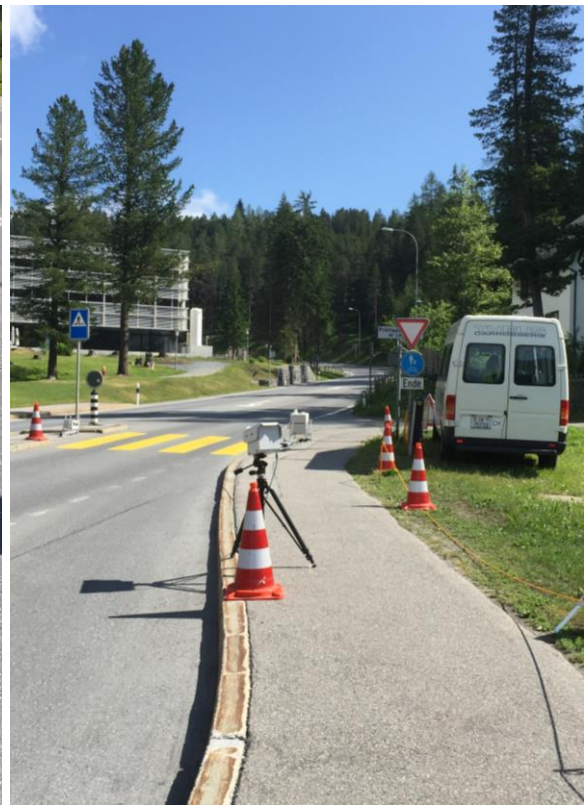
Abbildung 2: RSD-Messsystem bei Davos Wolfgang. Oben links: Lichtquelle und Spektrometer, oben rechts: Lichtquelle, Geschwindigkeits- und Beschleunigungsmesser, unten links: Kamera zur Erfassung von Kennzeichen (Foto der Fahrzeugrückseite und anschließende Kennzeichenerkennung), unten rechts: Übersicht mit Messfahrzeug, Lichtquelle und Reflektometer (Mittelinsel).
