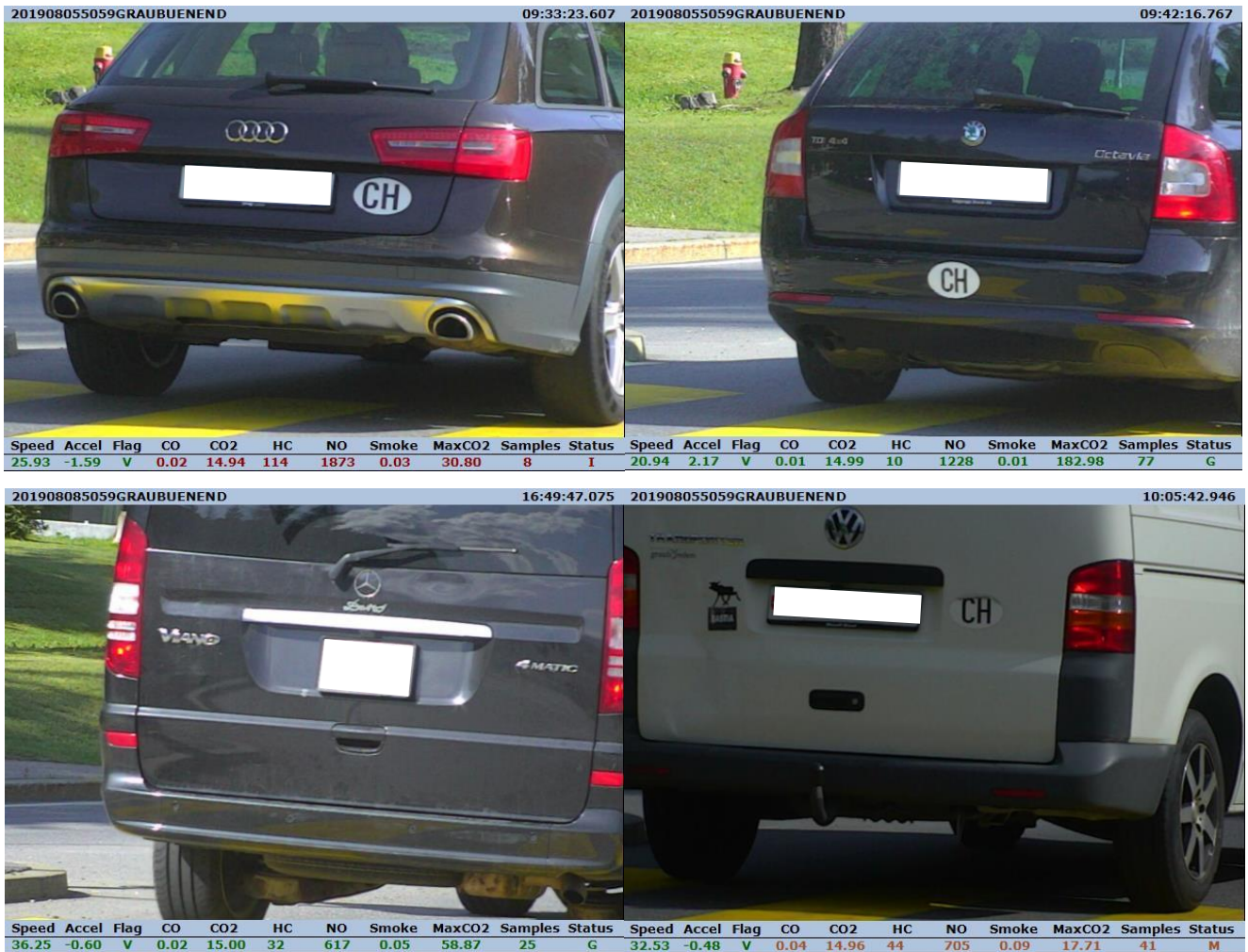
Abbildung 3b: Beispiele von Kameraaufnahmen während einer RSD-Messung. Das Bild zeigt jeweils das gemessene Fahrzeug. Auf dem Bild sind zudem die Schadstoff-Konzentrationen sowie Informationen zu Geschwindigkeit und Beschleunigung des Fahrzeuges ersichtlich. 1. Reihe: Personenwagen Diesel, 2. Reihe: Lieferwagen Diesel.
